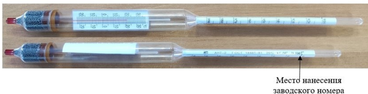
Рисунок 2 - Общий вид ареометров стеклянных для нефти модификации АНТ-2
